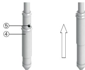
2. На необходимой глубине потяните устройство примерно на 10 см назад. Таким образом подвижная муфта откроет отверстие для заполнения.
