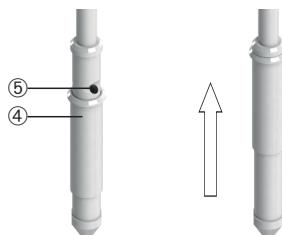
2. A la profundidad deseada, retire el instrumento aproximadamente 10 cm. De esta forma, la funda abre automáticamente la cámara colectora.
