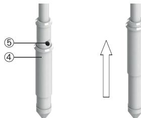
2. A la profondeur souhaitée, retirer le préleveur d'environ 10 cm. Ce faisant, le clapet d'opturation ouvre l'aperture de remplissage.
