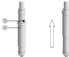
2. In gewünschter Tiefe das Gerät ca. 10 cm zurückziehen. Hierdurch öffnet die Verschlusshülse die Einfüllöffnung.
