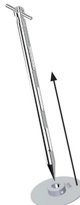
2. Установите ограничитель глубины на нужной высоте на пробоотборнике.
