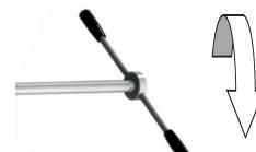
3. Nach ca. 5 Umdrehungen ist die Probenkammer gefüllt.
