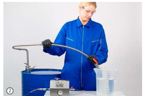
Mit dem Entnahmesystem für Lösemittel lassen sich hochreine Flüssigkeiten schnell und unkompliziert abfüllen. Mittels Druckgas (Druckluft oder Stickstoff) wird ein Überdruck im Gebinde hergestellt, der die Flüssigkeit aus dem Behälter fördert. Die Bedienung über Druckgas bietet den Vorteil, dass der Anwender ohne Mühe auch große Mengen entnehmen kann und dabei beide Hände frei hat, um das Lösemittel abzufüllen.
