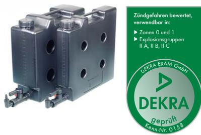
Der Raumsparkanister aus elektrisch leitfähigem HDPE ist speziell für den Einsatz in explosionsgeschützten Bereichen. Der Kanister hat mit einem spezifischen Oberflächenwiderstand von  $<10^5$  Ohm eine hohe elektrische Leitfähigkeit. Korrekt geerdet vermeidet er dadurch die Zündgefahr infolge elektrostatischer Aufladung. Somit hilft der Kanister den Anforderungen der Richtlinien ATEX 137, TRBS2153 und CENELEC 50404 zu entsprechen.
